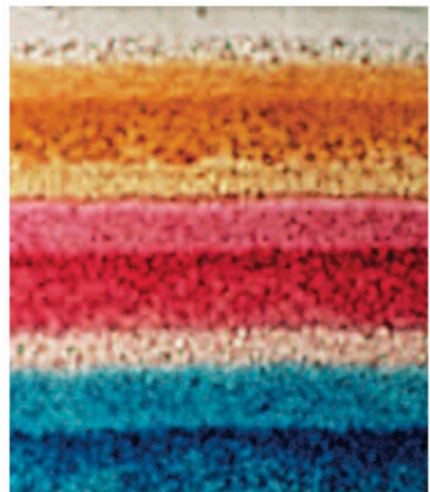
Vue en coupe d'un film couleur après développement
